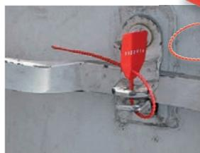
Composé d'une platine de 28 x 35 mm en polypropylène. Large de 2,5 mm et long de 251 mm. Résiste à une traction de 8,5 kg. Destiné à la traçabilité des remorques des camions, des containers et du matériel légalement soumis à des normes de suivi.
