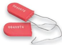
Platine de 40 x 20 mm en polypropylène. Crochet en acier zingué. Numérotation consécutive à 7 chiffres. Résiste à une traction de 31,8 kg. Adapté à la fermeture d'armoires et de caisses, au scellage de produits plus spécifiques tels que les fûts.
