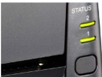
Sa facilité d'utilisation se poursuit grâce aux deux indicateurs LED qui indiquent le statut de l'imprimante. Les applications les plus courantes de la WS4 sont : l'étiquetage des échantillons et des produits, l'impression de bracelets, les mailings d'entreprises, les démarques.
