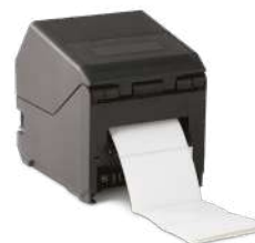
Chargement des supports en paravent par l'arrière
